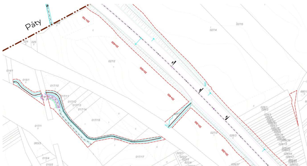
5. ábra Csapadékvíz-elvezetés terve új árok kialakításával az 1. sz. vasútvonal és az M1 autópálya között a 026/4 hrsz-ú ároktól dél-nyugatra
