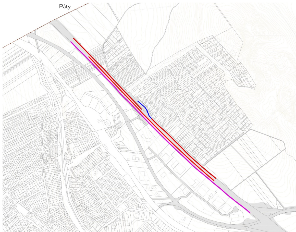
12. ábra: Meglévő zajvédőfal és zajvédőfal telepítése (meglévő kék, bordó jobb oldalra tervezett, vörös elválasztó sávba tervezett, lila bal oldalra tervezett)
